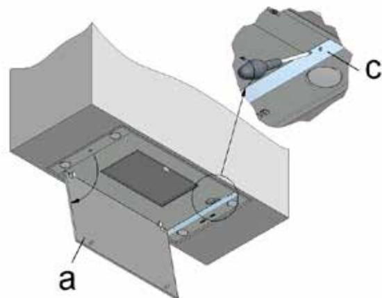
Kantel de onderplaat (a) naar beneden. Verwijder de 2 schroeven van de lichtbalk (c) met een kruiskopschroevendraaier.
