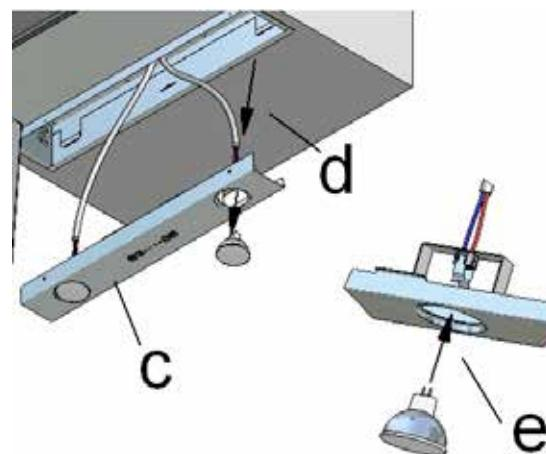
Laat de lichtbalk (c) nu voorzichtig naar beneden zakken. Verwijder de spot door deze langs de achterzijde naar beneden te drukken (d). Druk de nieuwe spot in de spothouder (e). Bevestig hierna de lichtbalk weer vast in de afzuigkap m.b.v. de 2 schroeven.
